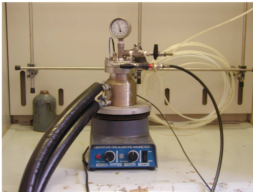
Figura 1.2: Apparato per la sintesi del clatrato di metano. Sono visibili i tubi del liquido refrigerante e il tubo collegato alla bombola di metano
