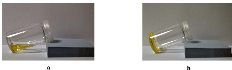
Figura 2.1: Test della provetta: a sinistra soluzione a caldo dell'organogelante (a) e a destra gel formato (b)
