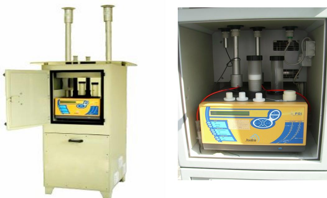
*Figura 1.1.5 – FAI Hydra Dual Sampler (con dettaglio sulla sinistra).*
