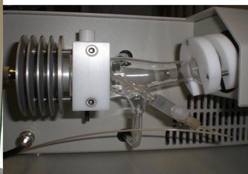
*Fig 1.2.4: Nebulizzatore ad ultrasuoni: particolare camera di nebulizzazione*
