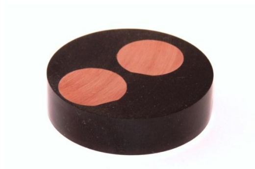
Figura 3.3 : Provini inglobati e lappati.
