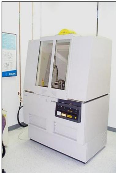
**Figura 3.1:** strumento "Philips X'PERT PRO" utilizzato per analisi attraverso raggi X.
