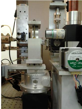
Figura 2.13: Particolare del supporto della cella: è ben visibile il goniometro che permette la rotazione della DAC rispetto al fascio.
