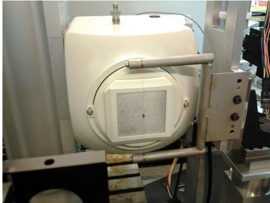
Figura 2.15: *Image detector per i raggi X: modello PI-SCX 4300.*
