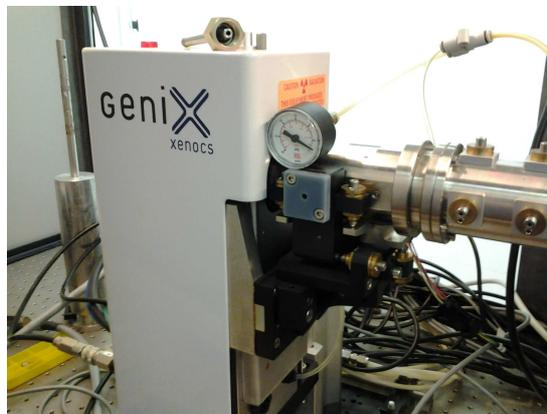
Figura 2.14: Generatore di raggi X: modello Xenonx-GeniX Mo Small Spot.
