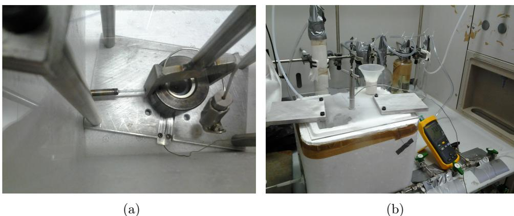
Figura 2.3: *Dettagli della procedura di caricamento. In 2.3a si osserva il posizionamento del capillare all'interno della DAC; in 2.3b, un momento della procedura di caricamento.*
