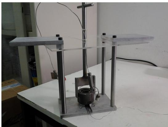
Figura 2.2: Base in alluminio realizzata per consentire il caricamento della DAC con gas esplosivi o corrosivi.
