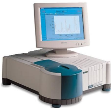
Fig.16: spettrofotometro UV-vis Varian Cary 50 BIO
