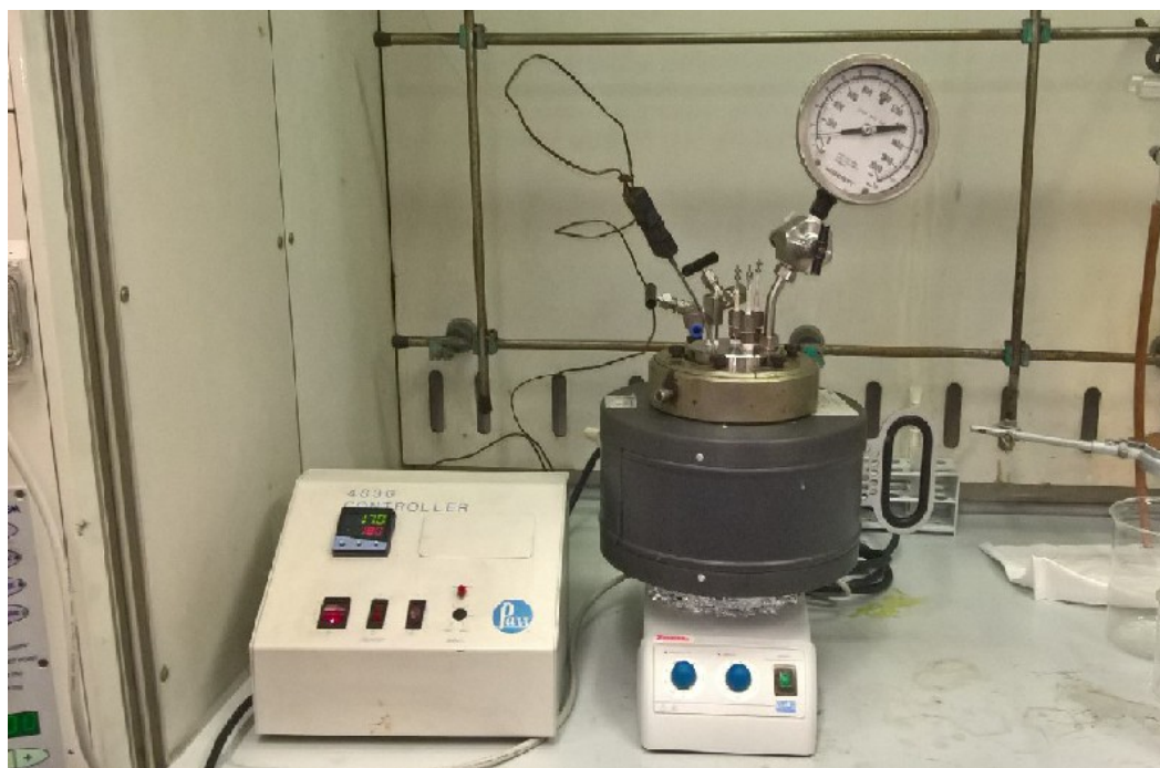
Figura 3: Strumentazione autoclave. A sinistra controller digitale per temperatura contrallata tramite uso di una termocoppia. A destra autoclave dentro camicia esterna riscaldante disposta sopra piastra oscillante.
