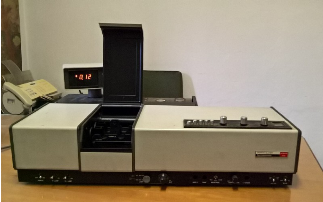
Figura 6: immagine spettrofotometro HITACHI model 200, PERKIN-ELMER.
