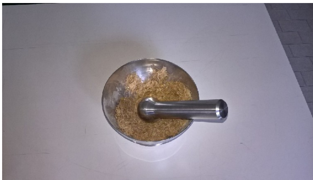
Figura 2: Macinazione della biomassa seccata tramite utilizzo di mortaio in metallo.
