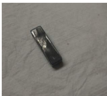
Figure 6 & 7: ZAMAK prima e dopo un lavaggio a ultrasuoni.
