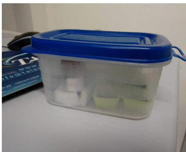
Fig. 10: Contenitore per il mantenimento dell'atmosfera ad umidità controllata per i campioni AFM
