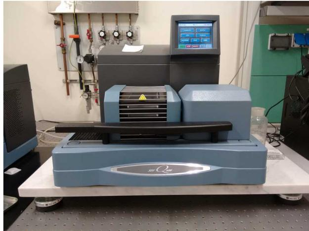
*Fig. 12: TGA SDT Q600 TA Instruments*
