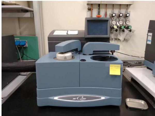
*Fig. 11: DSC Q2000 TA Instruments*
