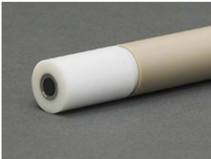
Figura 2.5 Elettrodo RDE montato sul supporto in Teflon (bianco)
