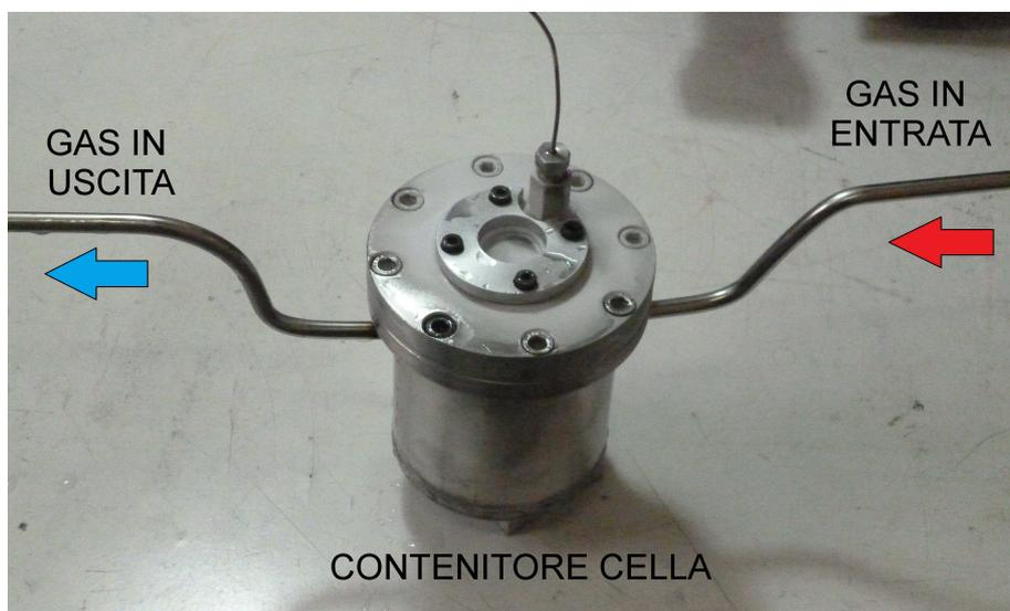
Figura 2.9: Foto del contenitore in acciaio, costituito da un tappo munito di valvola, che collega la DAC al compressore.
