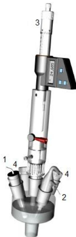
**Fig.2.2.1a** Cella elettrochimica: (1) elettrodo di riferimento Ag/AgCl, (2) filo di Pt avvolto intorno al gorgogliatore, (3) elettrodo di lavoro HMDE, (4) coni usati per le aggiunte.
