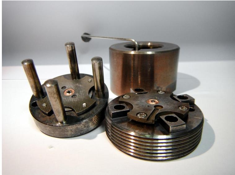
Figura 1.1: Esempio di una cella ad incudine di diamante
