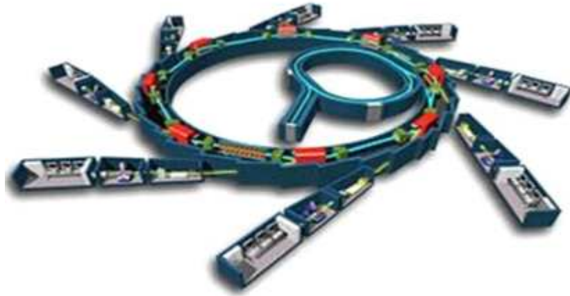
Figura 4: Struttura di un Sincrotrone, costituito dall'anello e dai beamlines
