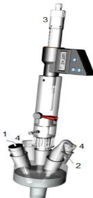
Fig. 2.2.1(a) cella elettrochimica: (1) elettrodo di riferimento Ag/AgCl; (2) gorgogliatore attorno al quale è avvolto il controelettrodo di Pt; (3) elettrodo di lavoro HMDE; (4) coni usati per le aggiunte.
