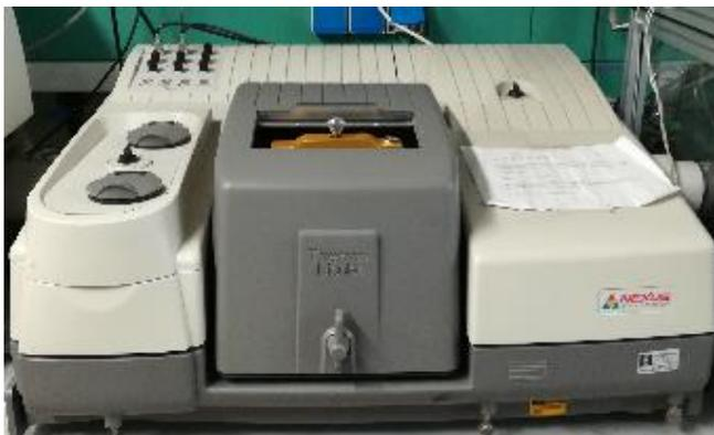
*Figura 2.2* Spettrometro NEXUS 870 FT-IR con cui sono state fatte le misure nel vicino infrarosso e nell'infrarosso.
