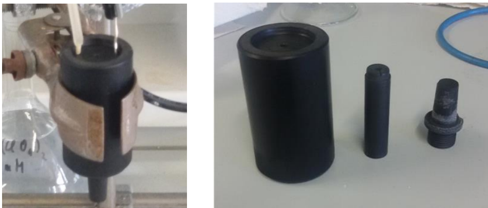
Figura 12: Cella per misure elettrochimiche montata per le misure e la stessa smontata in corpo, supporto per il retino e chiusura filettata.
